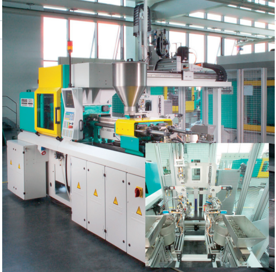
Bild 1. Gesamtansicht der Anlage zur Fertigung der Siebfilter für Getriebeöl (Fotos: FPT)
